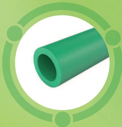
PP-R Pipe SDR 6 Series 6 According to DIN 8077/78 مواسير بولي بروبيلين
